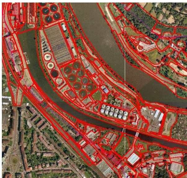
Rys. 37. Obraz poligonów o różnych wartościach współczynnika szorstkości
