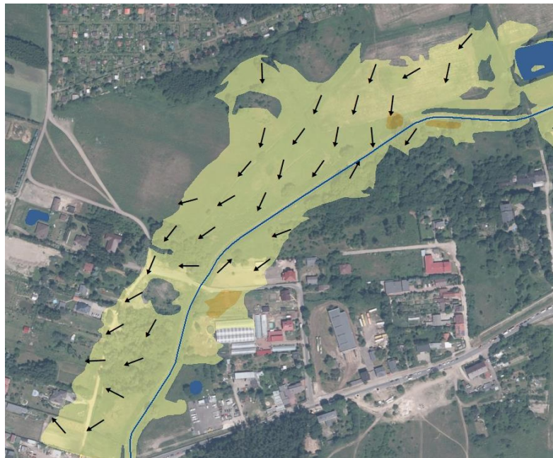
Rys. 57. Przykład poligonu maksymalnych prędkości wraz z kierunkami przepływu wody
